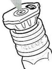
**Boquilla Blanca de 40°:** Esta boquilla ofrece un patrón de atomización de 40 grados y un chorro de agua menos potente. Con ésta boquilla puede cubrir una amplia área y debe usarse para la mayoría de los trabajos de limpieza general.
